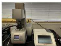
Rheo-Raman分光装置 (粘弾性測定+Raman分光)
