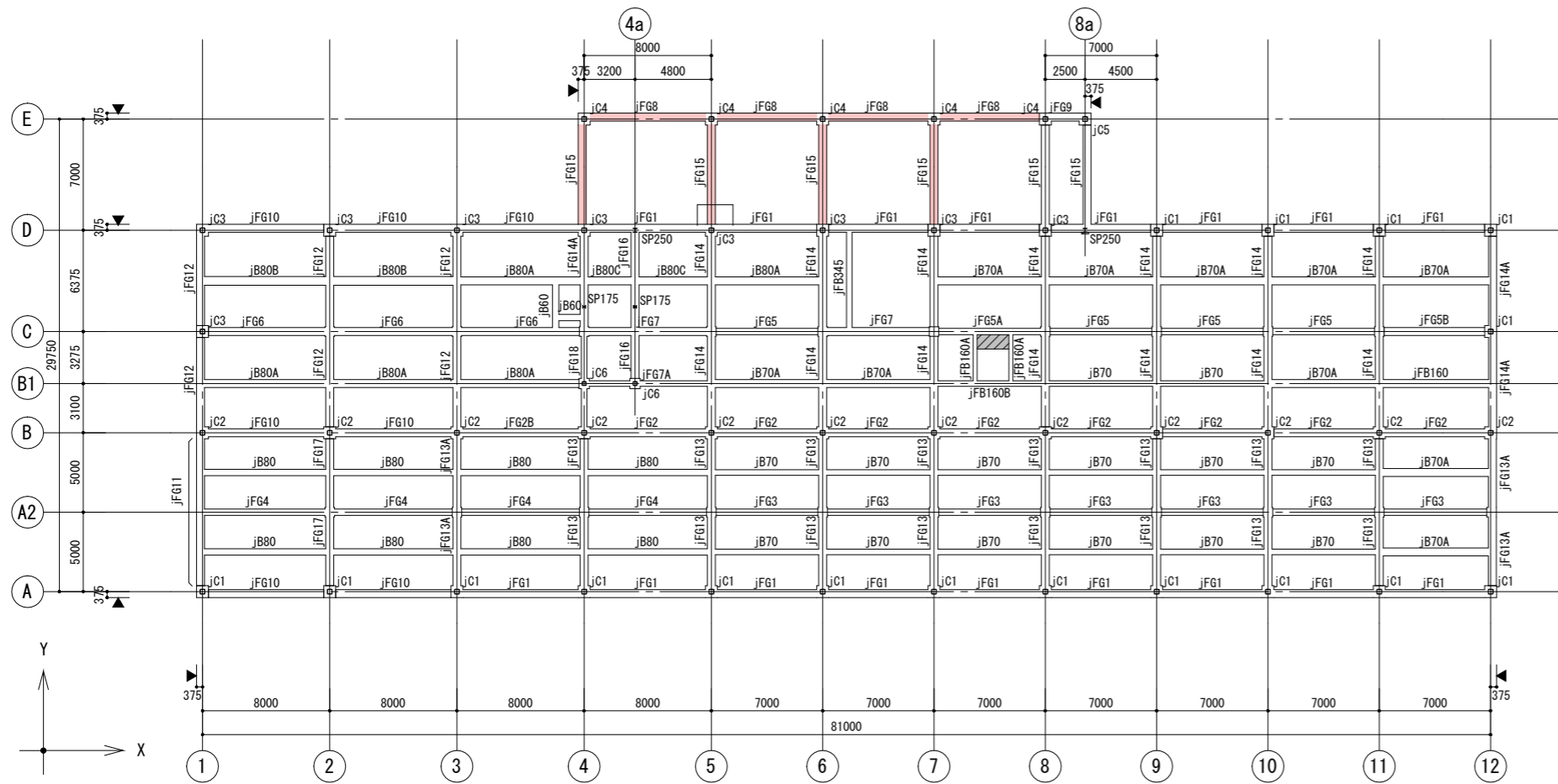
1階柱梁伏図(柱梁符号図) (見下げ図)
