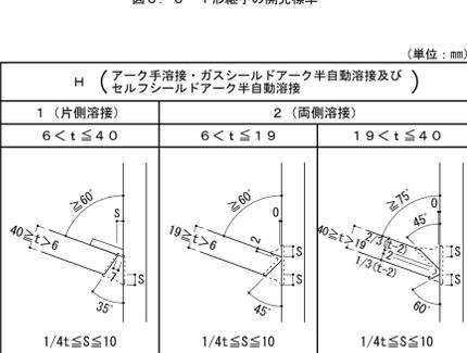
ウ かど継手(L)の開先標準は、図3.5による。
