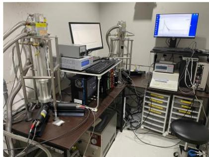
図2 材料中のナノメートル以下の空隙サイズを-200～200°Cの温度範囲で測定するための陽電子消滅寿命測定室。微小な空隙は例えばフィルム気体の透過性等と相関があります。
