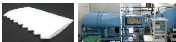
図3 前縁波形状翼を用いた翼性能向上
