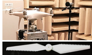
ドローンの翼の流体騒音低減(図2)
