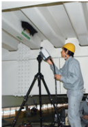
赤外線による損傷の非破壊検査
