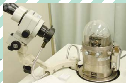
ナノ金属の精製に使用する、様々な評価装置。 原子間力顕微鏡 ▶
