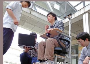
3次元距離センサを搭載した知的電動いす
