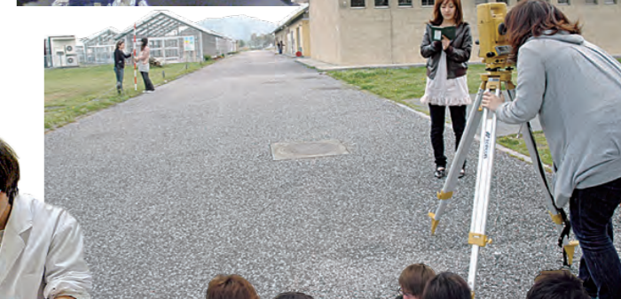
生物資源管理学実験・実習X トータルステーションで2点間の向き・距離を測量しているところ
