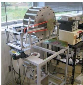
強度試験のためのガラスファイバー作製装置
