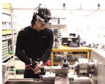
普通旋盤作業のシミュレータ
