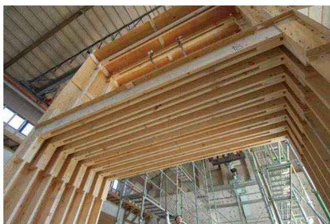
2層実大実験試験体
