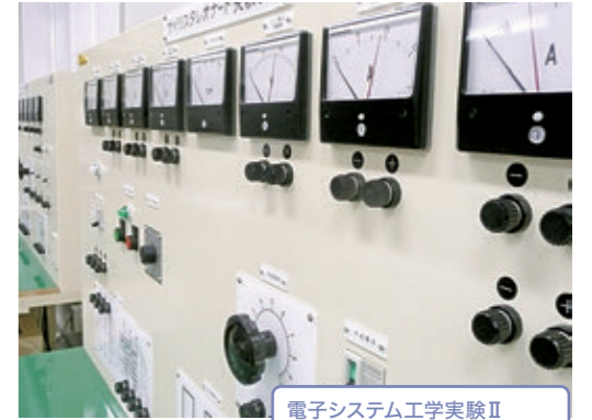
電子システム工学実験Ⅱ サイリスターレオナード実験装置
