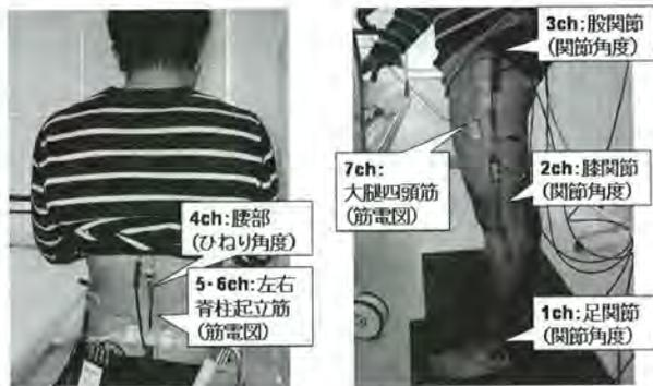
図2 データ取得のためのセンサー装置
