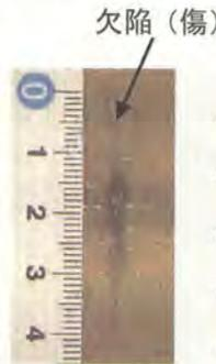
図 4 金属に発生した傷
