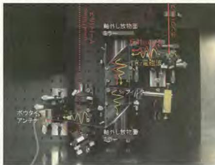
図 5: THz 電磁波測定系。
