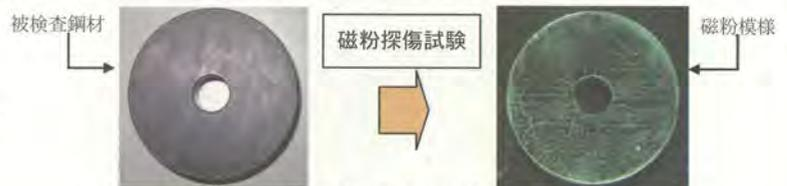
図 7 鋼材に発生した欠陥の磁粉模様
