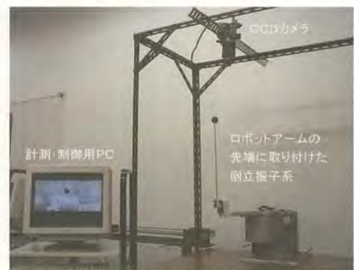
図6 視覚情報に基づく倒立振り子の制御
