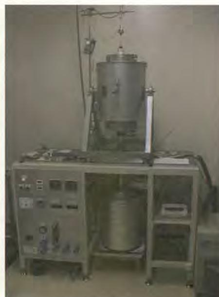
図3 落下型熱量計
