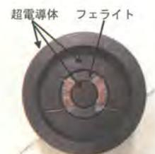
図 9 超電導磁気シールド変圧器
