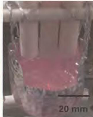
図2 高温用電気化学測定用セル
