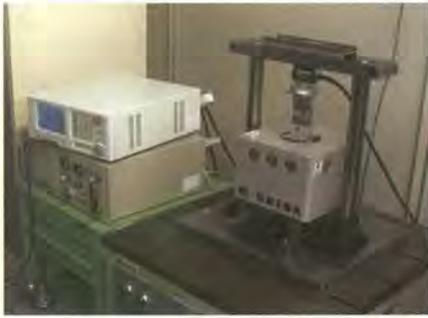
図3 極薄板材料用電磁加振式高速疲労試験機
