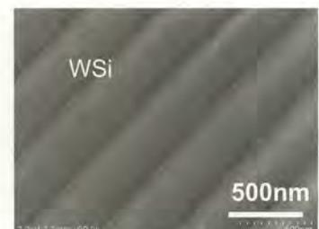
図 8: WSi を格子として作製した赤外偏光子の SEM 写真。
