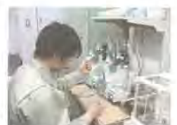
酸化劣化指標の滴定
