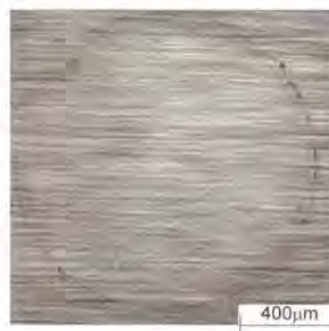
図2 球圧子押し込み試験によってTiN薄膜に発生したリングクラック
