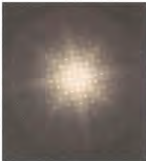
図5 自立膜型 SOFC において、燃料極界面近傍の電解質中に析出したスピネル型構造酸化物( \text{NiAl}_2\text{O}_4 )の電子線回折パターン
