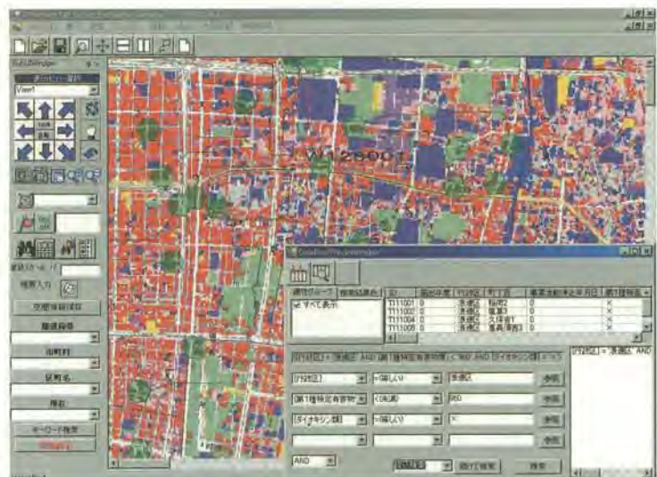
図3 開発した GIS (土壌汚染管理システム)
