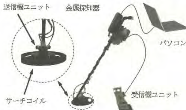
図1 手作業による金属反応の可視化システム概略
