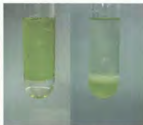
金水溶液とペプチドコポリマーゲル (左)捕集前, (右)捕集後
