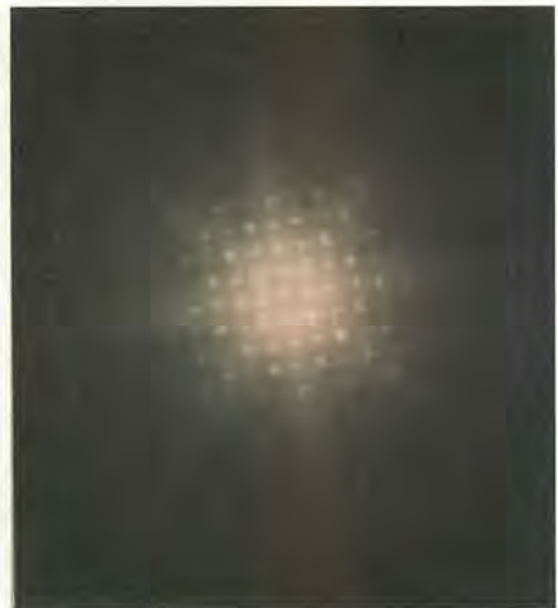
図5 自立膜型SOFCにおいて、燃料極界面近傍の電解質中に析出したスピネル型構造酸化物(NiAl 2 O 4 )の電子線回折パターン
