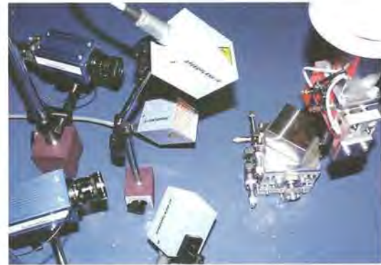
図4 ステレオ高速度カメラと同期型半導体レーザー照明装置の構成
