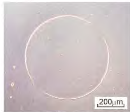
球圧子押し込みにより発生したリングクラック
