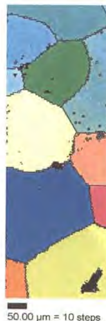
図2 OIMによる結晶方位マップ (純アルミニウム)
