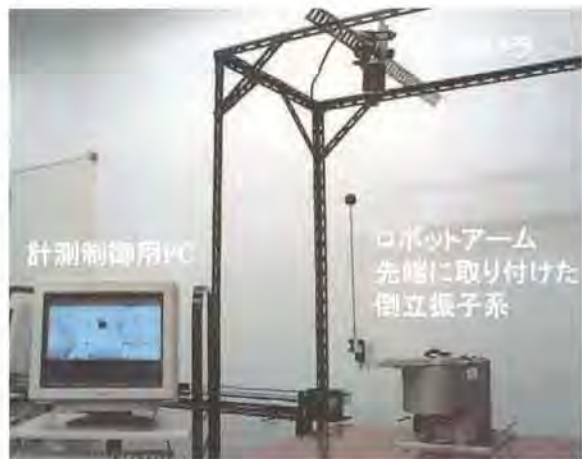
図2 視覚情報に基づく倒立振子の安定化制御
