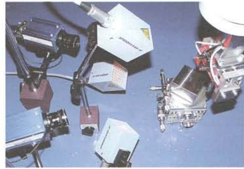
図4 ステレオ高速度カメラと半導体レーザ照明装置の構成
