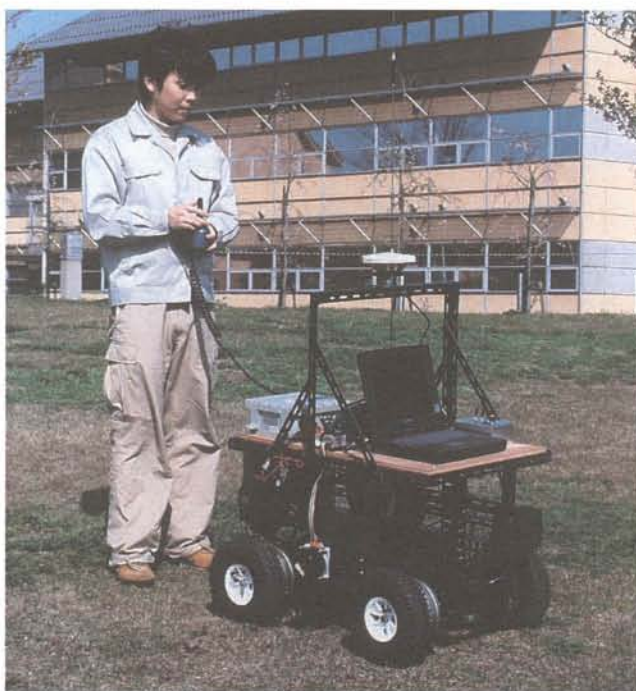
写真1 地中埋設物探索ローバー
