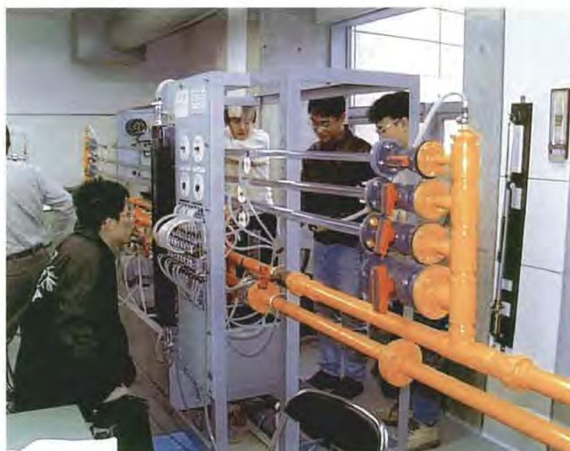
写真10 機械システム工学実験（管内摩擦損失の測定）
