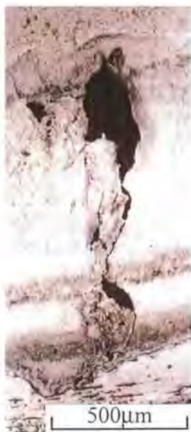
転がり疲労により発生した はく離形状
