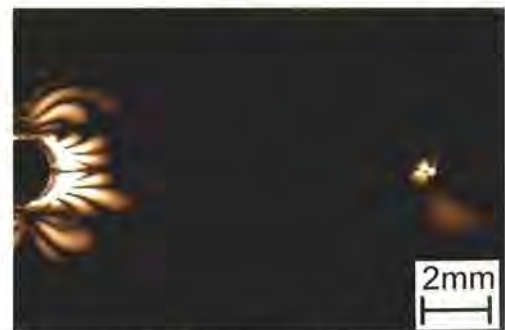
図4 光弾性効果によるDCDC試験片（ソーダ石灰ガラス）の等色線写真（ \sigma_0 = 123 \text{ MPa} ）
