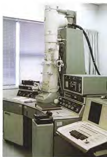
図2 組織観察のための透過型電子顕微鏡
