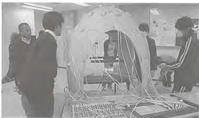
写真7 垂直荷重による破壊実験
