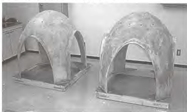
写真5 左官工事による仮設住宅モデル
