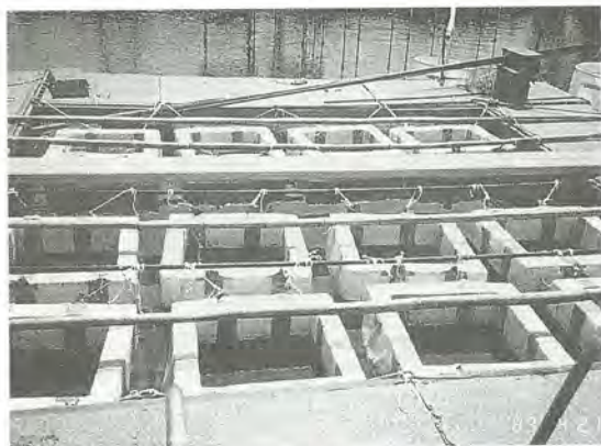
小型隔離水界—バッグ型(直径1m、深さ2~3m) 池に設置した浮遊型ポリエチレンバッグのメソコスムス、比較的容易に生体影響を研究できる。
