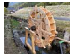
去年、8大学合同で制作された水車。各大学でそれぞれの担当パーツを加工後、現地で組み立てた。
