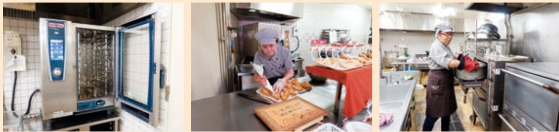
※スチームコンベクション 野菜やシューマイなどを蒸したり、魚を焼いたりする機械。 木村さんはこの機械を使って調理しています。
